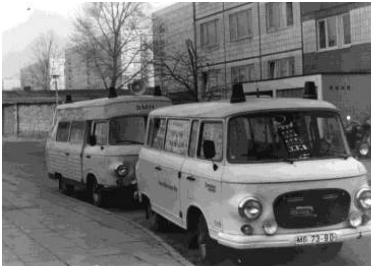
Zwei Generationen von SMH-Fahrzeugen auf Barkas B-1000-Fahrgestellen
